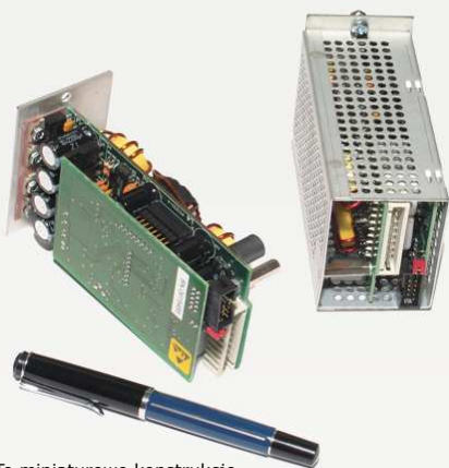
Te miniaturowe konstrukcje to wzmacniacze cyfrowe o mocy 520W rms
