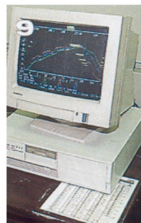
9. Po włożeniu do pieca, obwody zostają poddane obróbce termicznej, kontrolowanej na monitorze, do czasu aż klej nie zwiąże.
