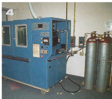
4. „Pokój tortur” dla urządzeń, włącznie z wibracjami oraz wysoką i niską temperaturą
