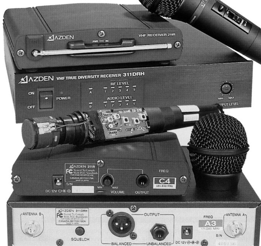
Azden w dwóch wcieleniach: jednoantennowym 211R i dwuantennowym, różnicowym 311DRH. Sztwyne zamocowanie kapsuły w nadajniku powoduje, że jest on podatny na pukanie w korpus.
