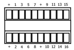
1. GPO 1 2. GPO 2 3. GPO 3 4. GPO 4 5. GPO 5 6. GPO 6 7. GPO 7 8. GPO 8 9. GPO 9 10.GPO 10 11.GPO 11 12.GPO 12 13.GPO 13 14.GPO 14 15.GPO 15 16.GPO 16
